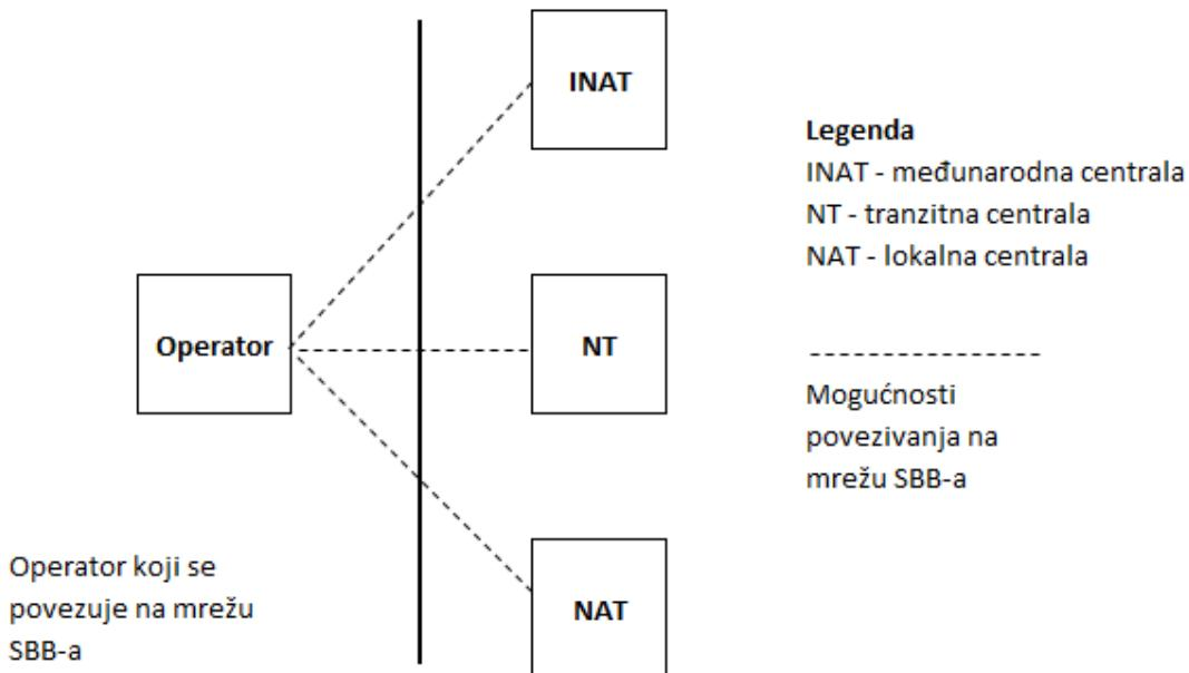
*Slika 1. Mogućnosti povezivanja operatora na mrežu SBB-a*
